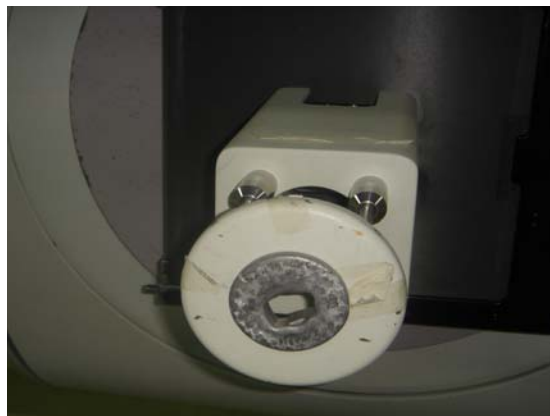
Campo pequeño irregular utilizado como ejemplo de dosimetría de electrones de alta energía utilizando película
